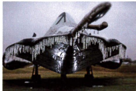
Givrage au sol
